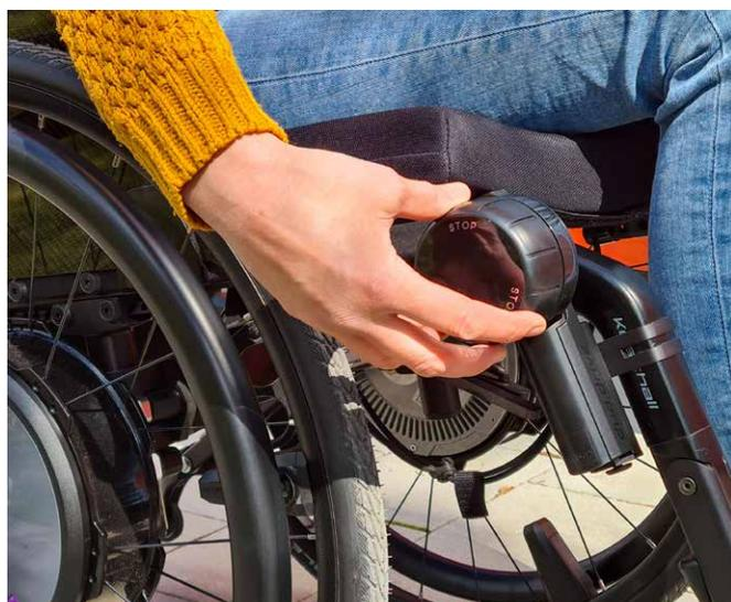
Eine Drehung am Bediengerät reicht aus und du wechselst während der Fahrt in den Cruise-Mode (Dauerfahrfunktion).
