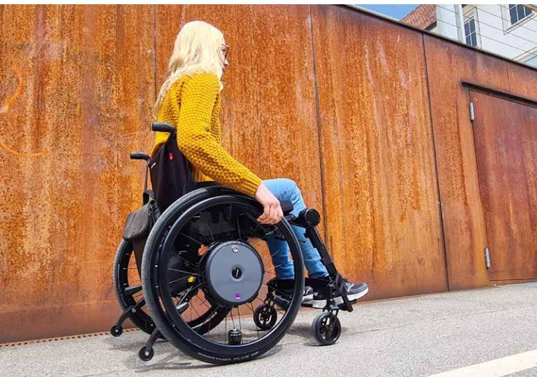
Das Konzept des e-motion DuoDrive ist genial einfach: Du kannst die e-motion **Antriebsräder** über zwei Adapter mit beinahe jedem handelsüblichen Rollstuhl kombinieren. Während der Fahrt messen eingebaute Sensoren in den Greifreifen deine Anschubbewegung und stellen dir die gewünschte Motorkraft zur Verfügung. So kannst du deinen Rollstuhl schon mit sehr wenig Kraft fahren, lenken und bremsen.
